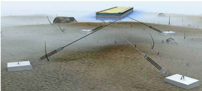
Figur 3. Förankring av bryggor med betongankare.
